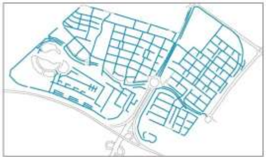
Progetto e rete di raccolta delle acque piovane del quartiere sostenibile di Valdespartera, Saragozza
